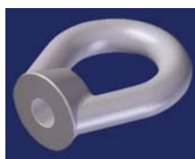
Porca Olhal Elíptica M16 Ferro Nodular 50KN. Galvanizado por imersão a quente.
