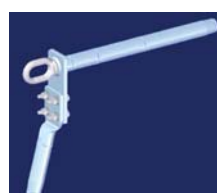
Grampo de Ancoragem à Compressão Liga de alumínio e terminal em aço forjado galvanizado por imersão a quente.
