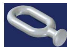
Concha Olhal Aço forjado 120 KN Engate IEC 16. Galvanizado por imersão a quente.
