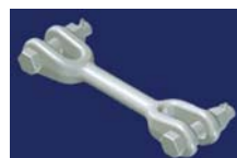
Prolongador Garfo Garfo Aço forjado 120 KN. Galvanizado por imersão a quente.
