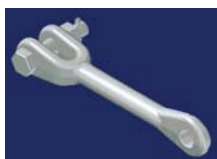
Prolongador Garfo Olhal Aço forjado 120 KN. Galvanizado por imersão a quente.
